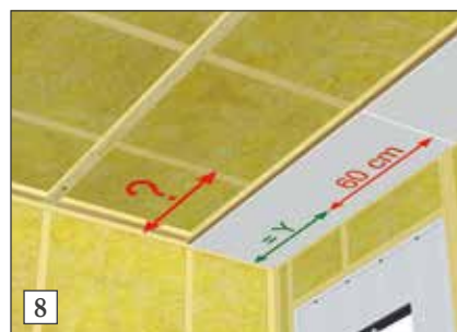
8) For å finne lengden på 1. plate i 2. platerad tar man lengden på 1. plate i 1. platerad minus 60 cm.
