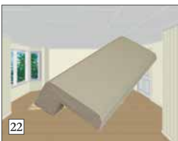
22) Vi kan tilby kombigerikt (foring/gerikt) til bruk rundt vinduer og dører, der det monteres et ekstra platelag direkte på eksisterende plater/panel under oppussing.
