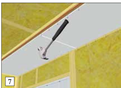
7) Skjøtene skal ikke limes. Spikeravstand er c/c 150 mm. For å unngå skader på platen utføres siste spikerslag med dor. Kramper og skruer kan også benyttes (se mont.veil. M005-08-04).
