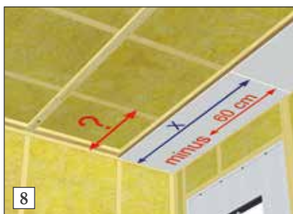
8) For å finne lengden på 1. plate i 2. platerad tar man lengden på 1. plate i 1. platerad minus 60 cm.
